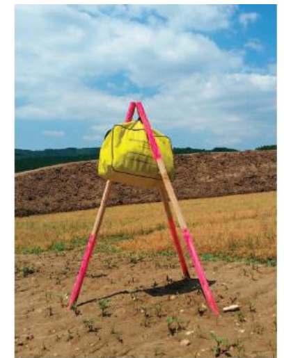
Figure 77 : Exemple d'un kit anti-pollution isolé du sol (Source : Guide des bonnes pratiques environnementales -Protection des milieux aquatiques, AFB 2018)
